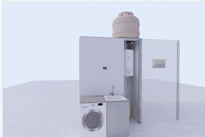
El mismo panel, equipado: cocina, lavadero y baño se cuelgan de las salidas previstas de fábrica.
